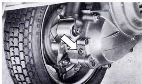
Fig. 11 - Foro di scarico « A » e carico « B » dell'olio del motore.
