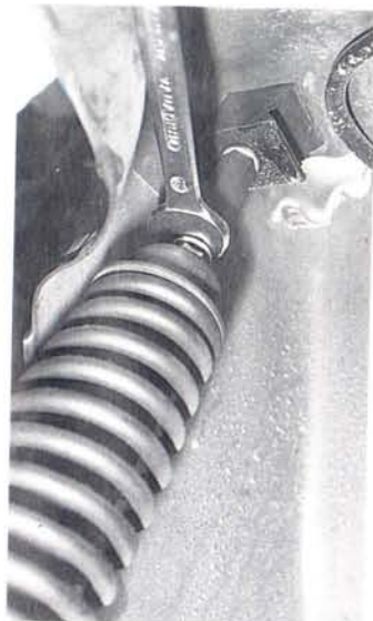
Abb. 291 Überprüfung der Schwingenlage- rung: Fahrzeug- heck abstützen, frei hängende Antriebsseinheit quer zur Fahrtrich- tung hin- und herbewegen
