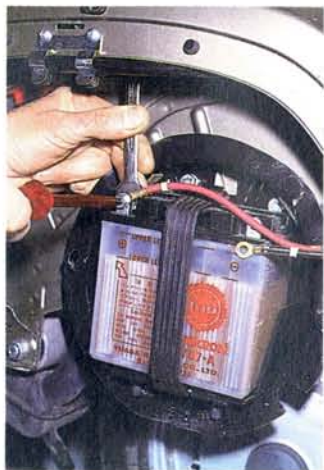
Abb. 73 Dann erst das rote Kabel vom Pluspol abnehmen; Mutter gegenhalten
