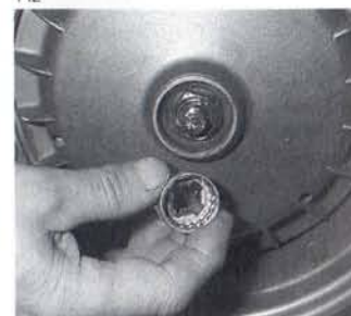
Abb. 142 Mit einem Sei- tenschneider Splint am Achs- zapfen aufbiegen, Splint entfernen
