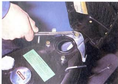
Abb. 223 Benzin- und Öltank zusammen aus dem Chassis heben
