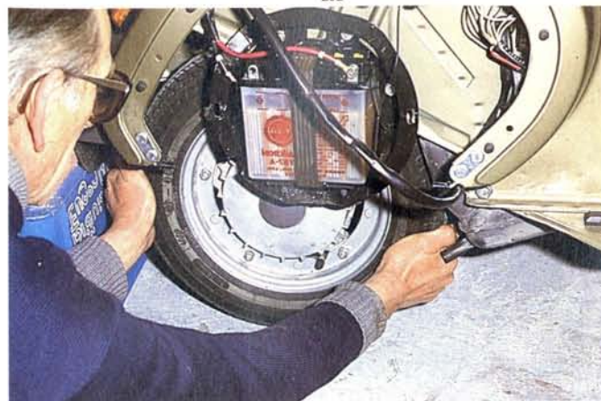
Abb. 293 Prüfung des Radlagerspiels hinten: Rad quer zur Achse hin- und herziehen
