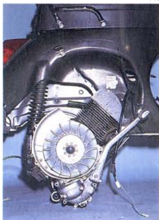
Abb. 111 Motor komplett bis zum Boden absenken, im Bild das Triebwerk der PX 200 E Lusso 1984
