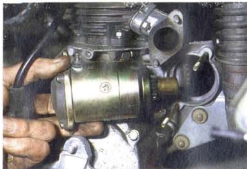
Abb. 214, 215 Den Anlasser zum Zerlegen am besten ganz aus dem Getriebegehäuse herausnehmen. Anlasserritzel und Zahnrad am Rotor von der rechten Fahrzeugseite
