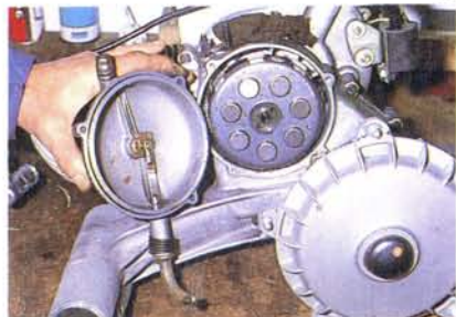
Abb. 191 Nach Abklappen des Deckels kann die Kupplung demontriert wer- den; der Spreng- ring sitzt innen
