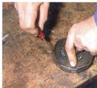
Abb. 201, 202 Kupplung von Hand oder mit Klotz und Hebel niederhalten und Sprengring ent- fernen. Anschlie- ßend läßt sich die Kupplung in ihre Einzelteile zerlegen.
