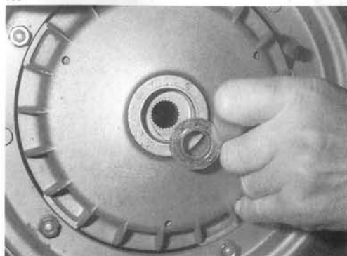
Abb. 159 Kronensicherung von der Achszapfenmutter abnehmen
