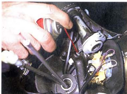
Abb. 175 Das Spiel am Handhebel soll zwei bis drei Millimeter betragen
