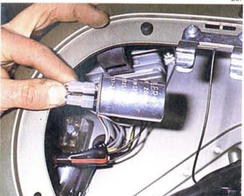
Abb. 266 Ausbau der kompletten Blinker beim PX-Modell: Schrauben und Muttern lösen
