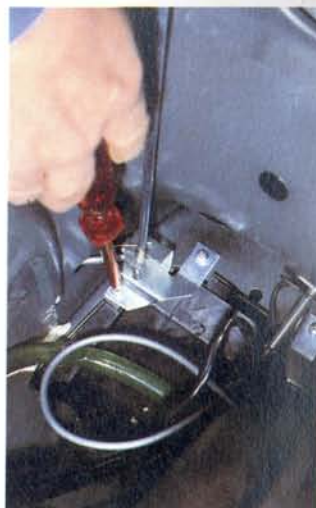
Abb. 239 Der Seilzug wird samt Hülle aus dem Schacht gezogen; das Kabel bleibt im Tunnel und dient beim Einziehen des neuen Zugs als Manövrierteile
