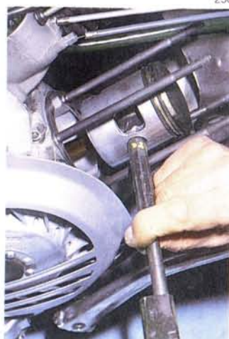
Abb. 256 Bei abgenommenem Zylinder kann der Kolben ausgebaut werden; zuerst Seegeringe am Kolbenbolzen mit einer Seegeringzange ausfedern
