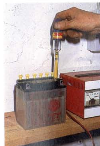
Abb. 131 Mit einem Säureheber läßt sich das spezifische Gewicht der Säure in den Zellen ermitteln
