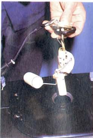
Abb. 226 Geber vorsichtig nach oben aus dem Tank ziehen und durchprüfen
