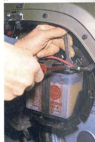
Abb. 70 Vergaserausbau PK-Modelle: Die Schraube am Klemming läßt sich am besten mit Knarre und kurzer Verlängerung erreichen
