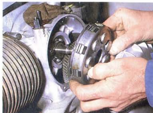
Abb. 201, 202 Kupplung von Hand oder mit Klotz und Hebel niederhalten und Sprengring ent- fernen. Anschlie- ßend läßt sich die Kupplung in ihre Einzelteile zerlegen.
