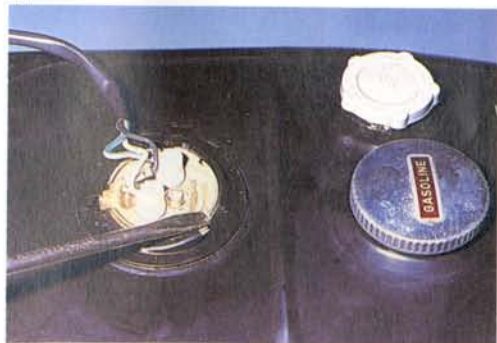
Abb. 224 Prüfen, ob die Verschraubung des Ausflußröhrchens fest sitzt; der Schlauch muß so gesichert sein, daß er auf keinen Fall abrutschen kann
