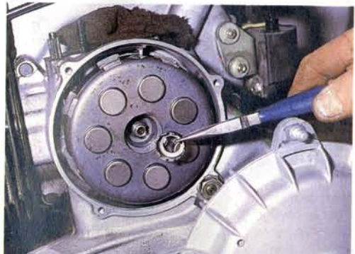
Abb. 198 Kupplungskorb blockieren und Spezialmutter mit dem Zahneisen lösen
