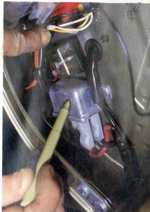
Abb. 269 Das Anlasserrelais befindet sich unter der linken Haube
