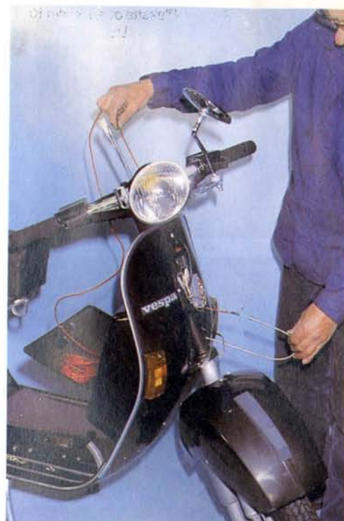
Abb. 239 Der Seilzug wird samt Hülle aus dem Schacht gezogen; das Kabel bleibt im Tunnel und dient beim Einziehen des neuen Zugs als Manövrierteile
