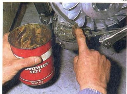
Abb. 126 Schaltsegment fetten bei den PK- Modellen: Von unten die Kappe abschrauben
