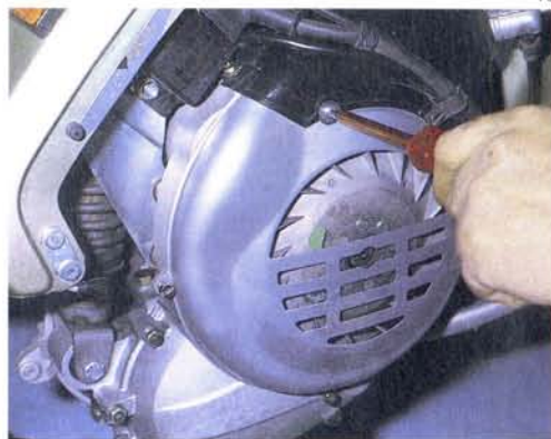
Abb. 79, 80 Zum Motorabklappen am besten auch die Elektronikzentrale lösen – zwei Muttern SW 10 Lüfterhaube und Lüfterdeckel sind gemeinsam mit Kreuzschlitzschrauben befestigt
