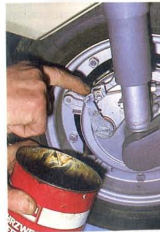
Abb. 128 Das Ende der Tachowelle sollte ebenfalls ab und zu gefettet werden
