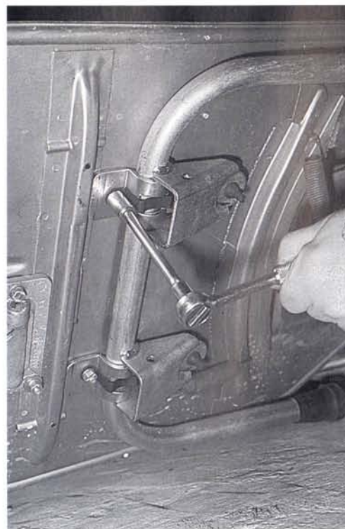
Abb. 297, 298 Felgenreife abnehmen, Reifen und Schlauch wechseln; vor dem Zusammen bau Rost an den Ring bekämp fen. Zum Abbau des Mittelstän ders Maschine auf die Seite legen; dabei dar auf achten, daß weder Benzin noch Batterie säure auslaufen können
