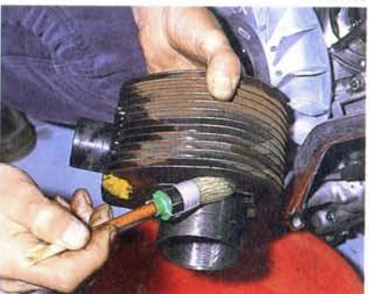
Abb. 117 Reinigung des Kolbenbodens bei ausgebautem Zylinder. Die Kur- belwanne muß sorgfältig abge- deckt werden
