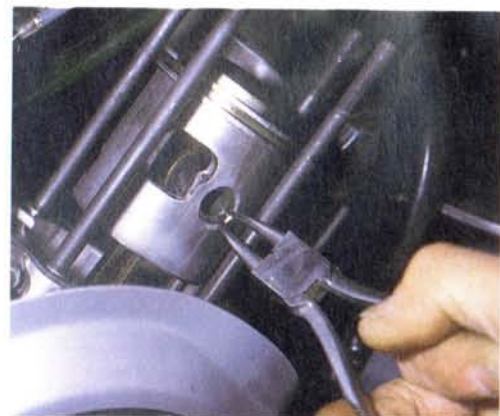
Abb. 256 Bei abgenommenem Zylinder kann der Kolben ausgebaut werden; zuerst Seegeringe am Kolbenbolzen mit einer Seegeringzange ausfedern
