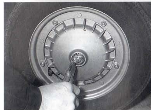
Abb. 142 Mit einem Sei- tenschneider Splint am Achs- zapfen aufbiegen, Splint entfernen
