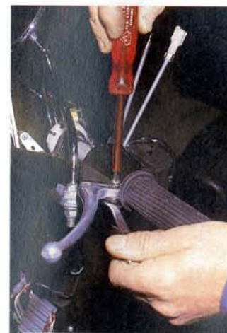
Abb. 171 Züge hochhalten und aus der Spraydose mit Schmiermittel versorgen; fünf Minuten lang durchziehen lassen
