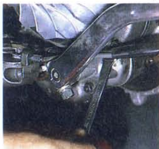
Abb. 182 PX-Modelle: Halter für die Schaltzüge vom Motorblock abschrauben
