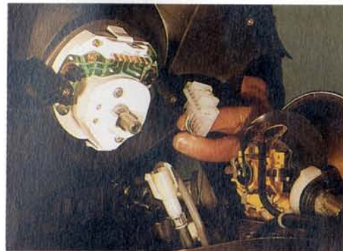
Abb. 229 Tachometer nach oben aus der Lenkerverkleidung herausnehmen; dabei auf die Gummidichtung achten
