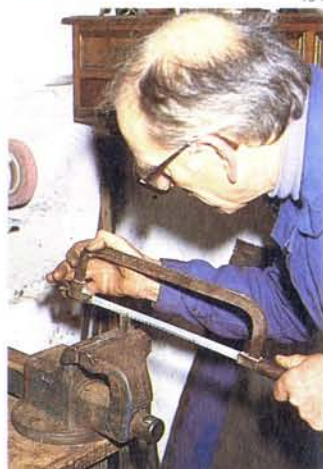
Schlüssel für die Spezialmutter selbst an. Einfach aus einem Stück Flacheisen zwei passende Zähne heraussagen
