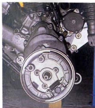
Abb. 188 Kupplungsausbau bei den PK-Modellen: Hinterradbremstrommel abnehmen und Ankerplatte komplett mit Brems-elementen abschrauben (drei Muttern SW 13)
