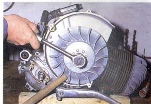
Abb. 205 Zur Rotordemon- tage zunächst die Verschraubung lösen; Rotor mit einem Rundholz blockieren
