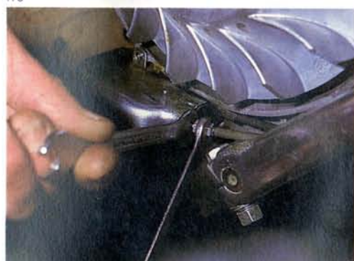
Abb. 176 Der Einsteller für die Kupplung ist unter dem Motor-/Getriebeblock
