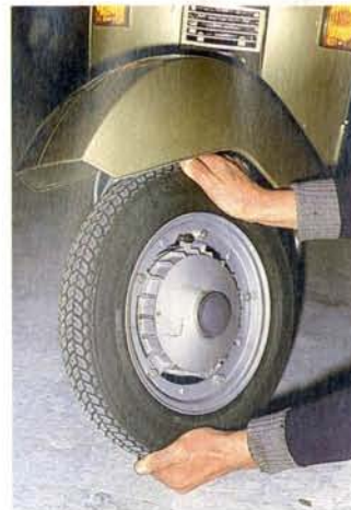
Abb. 292 Prüfung des Rad- lagerspiels vorn: das frei hängende Rad quer zur Achse bewegen
