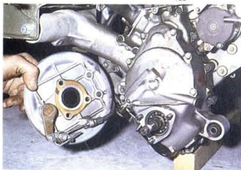
Abb. 189 Ankerplatte seitlich wegklappen; Papierdichtung später möglichst erneuern
