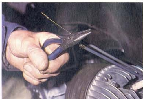
Abb. 230 Defekte Kontroll- lampen zusam- men mit den Fas- sungen aus dem Kombiinstrument ziehen
