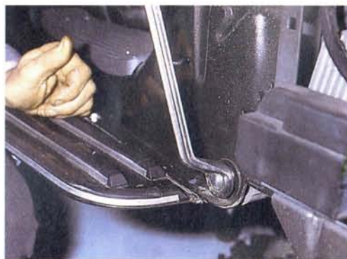
Abb. 186 Mit einem passenden Ringschlüssel die Mutter der Traversenachse lösen, Achsenkopf auf der rechten Fahrzeugseite festhalten
