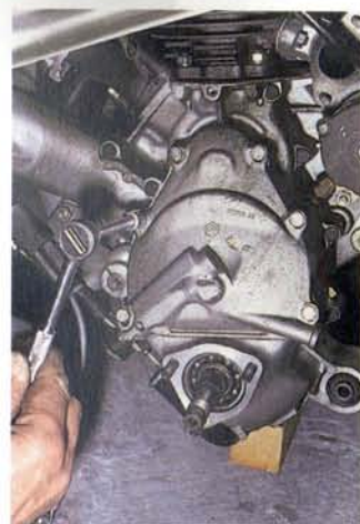
Abb. 190 Der Kupplungsdeckel ist mit sechs Schrauben SW 10 befestigt
