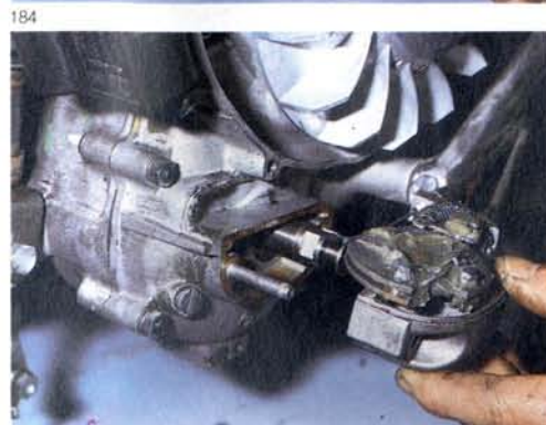
Abb. 184 Schaltsegment abnehmen, dazu zwei Muttern SW 11 abschrauben
