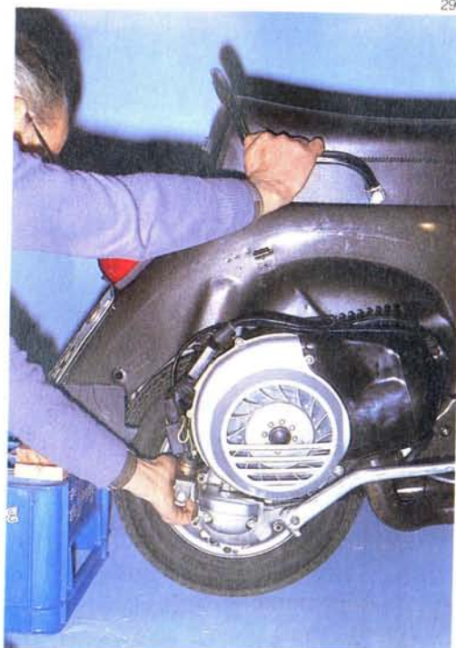
Abb. 291 Überprüfung der Schwingenlage- rung: Fahrzeug- heck abstützen, frei hängende Antriebsseinheit quer zur Fahrtrich- tung hin- und herbewegen
