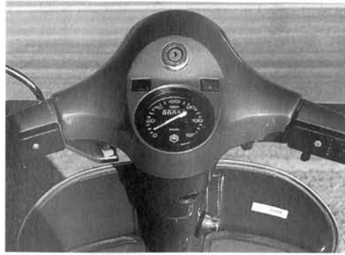
Abb. 39 Die Lenkung muß sich leicht hin- und herbewegen lassen. Sonst ist ein Austausch der Steuerrohrlager fällig
