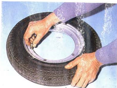
Abb. 294 Wechsel von Reif en und Schlauch — einheitlich vorn und hinten bei allen Modellen: Zuerst Luft ablassen
