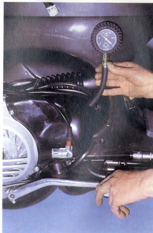
Abb. 255 Zum Prüfen der Kompression einen Kompressionsprüfer in die Zündkerzenbohrung einsetzen und Kickstarter betätigen
