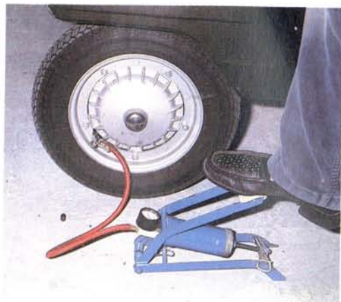
Abb. 132 Der Luftdruck in den Reifen sollte alle 14 Tage geprüft und korrigiert werden
