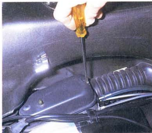
Abb. 60 Luftfilterausbau bei den PX- Modellen: Motor- haube abnehmen und Gehäusedek- kel abschrauben
