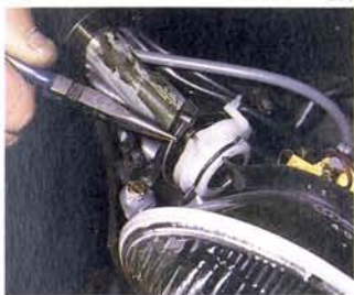
der Rolle abge- nommen; vorher Nippel im Schalt- segment lösen
