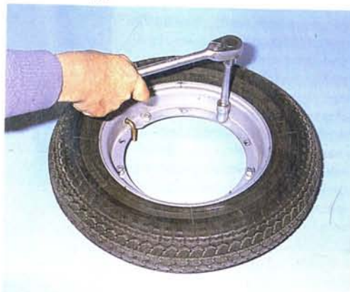
Abb. 295 Die Muttern lösen, von denen die Felgenreife zusammengehal ten werden
