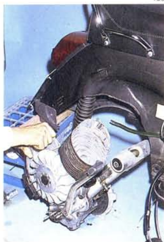
Abb. 187 Motor-/Getriebeblock (PX 200 E) komplett aus dem Fahrgestell herausnehmen
