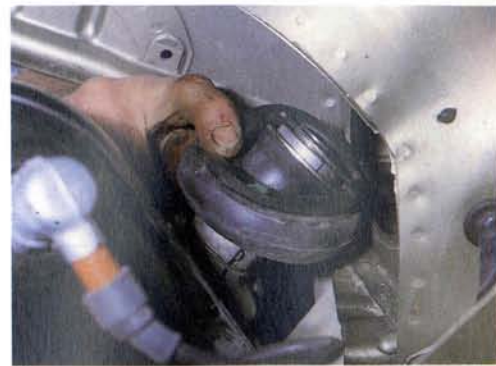
Abb. 82 Die Gummitülle zwischen Ansaugrohr und Karosserie abziehen (nur PK-Modelle)
