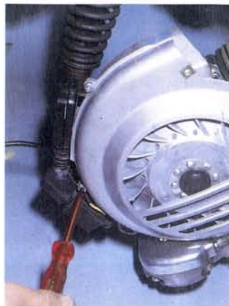
Abb. 110 Der Lüfterdeckel ist am Rand mit dem Motorblock verschraubt
