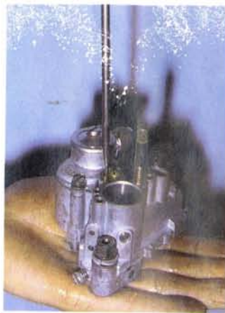
Abb. 254 Alle Düsen von Zeit zu Zeit ausdrehen und durchblasen
