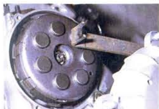
einem Schrau- bendreher in das größere der bei- den Löcher fahren und Feder zur Mitte hin drücken
