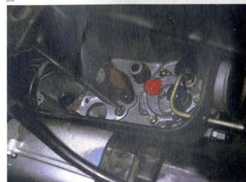
Abb. 95 Der Vergaser ist mit zwei Schrau- ben SW 11 am Motor befestigt
