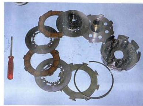
Abb. 203 Die Einzelteile der PX-Kupplung von rechts oben gegen den Uhr- zeigersinn: Korb mit Federn, Druckscheibe, Primärtrieb, Reib- und Mitneh- merscheiben, Basisplatte, Sprengring
