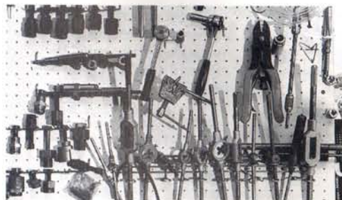
Abb. 49 Zum Nachschneiden von Schrauben und Muttern sind spezielle Werkzeuge mit auswechselbaren Einsätzen erforderlich
