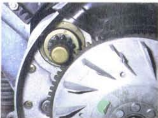
Abb. 214, 215 Den Anlasser zum Zerlegen am besten ganz aus dem Getriebegehäuse herausnehmen. Anlasserritzel und Zahnrad am Rotor von der rechten Fahrzeugseite
