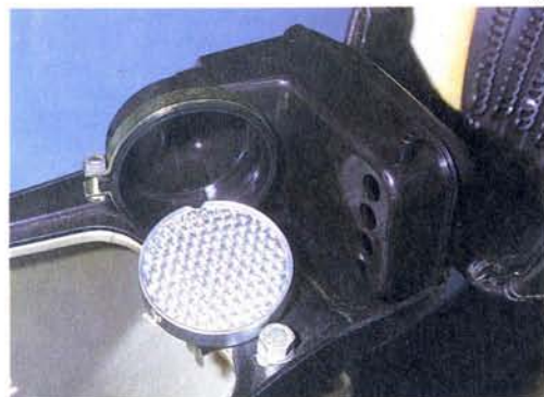
Abb. 58 Luftfilterausbau bei den PK- Modellen: Sitz- bank hochklap- pen, Werkzeug- mulde entfernen, Filterverschrau- bung lösen
