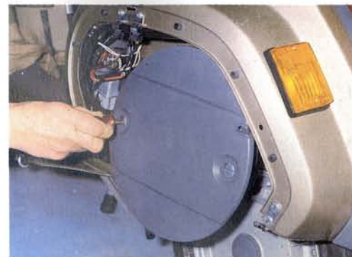
Abb. 70 Vergaserausbau PK-Modelle: Die Schraube am Klemming läßt sich am besten mit Knarre und kurzer Verlängerung erreichen
